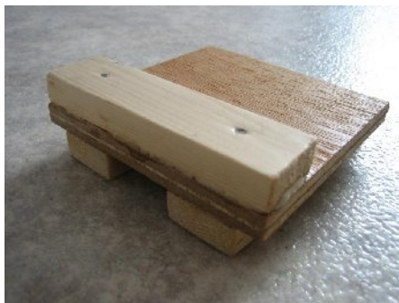
Het schuifblok van de bovenzijde...
