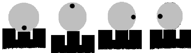
Hoekverdraaiing: verplaatsing van het trefpunt in de richting waarin de korrel in de keep is gepositioneerd
