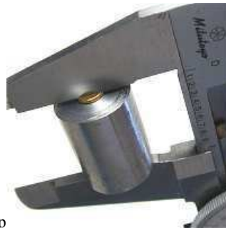
Randdiktemeter gemaakt van een stukje metaal of geweerloop
