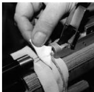
...en plaats direct achter de kamer een lap over het lucht toevoerkanaal.
