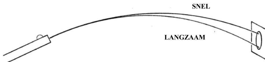
Vertikale afwijkingen als gevolg van snelheidsverschil van de kogels
