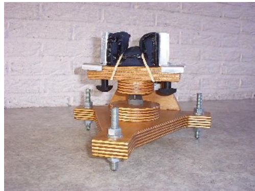
Doe-Het-Zelf verstelbare frontrest voor geweer gemaakt van hout, een scharnier, verstelbare aluminium wangplaten, canvas zakje met zand en wat bouten en moeren,...
