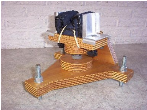
Doe-Het-Zelf verstelbare frontrest voor geweer gemaakt van hout, een scharnier, verstelbare aluminium wangplaten, canvas zakje met zand en wat bouten en moeren,...
