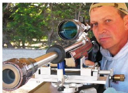
"One-Piece Rest" met vrije beweging en stop Het geweer reageert op natuurlijke wijze.
