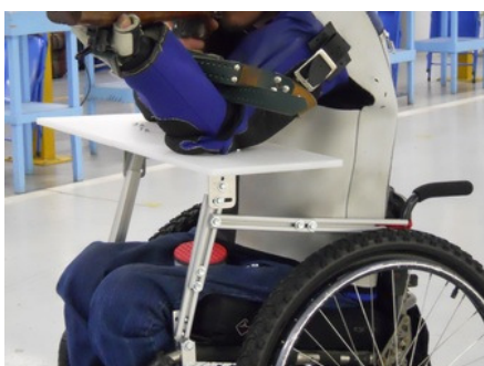
Schiettafel speciaal voor een rolstoel
