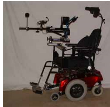
Equalizer Adaptive Shooting Systems LLC. BE Adaptive Model HQ100 is een rolstoelmontage voor schutters die hun handen en armen niet kunnen gebruiken. Trekkeractivatie d.m.v. sip-and-puff systeem.
