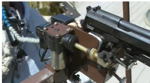
trekkermechanisme gemaakt van een autodeur actuator
