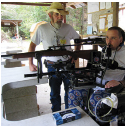
Richten d.m.v. een joystick, en trekkerbediening door Sip-and-Puff systeem
