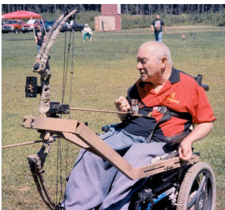
Richten d.m.v. een joystick, en trekkerbediening door Sip-and-Puff systeem
