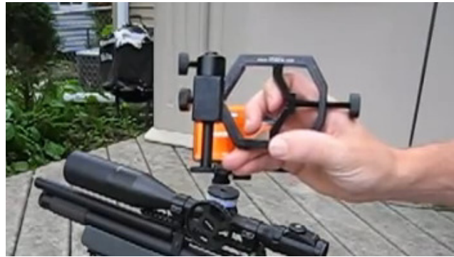
Seben MKA2 camera montage (klem voor een telescoop waaraan een normale digitale fotocamera gemonteerd kan worden)
