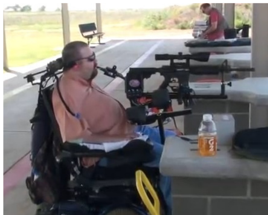
Richten d.m.v. een joystick, en trekkerbediening door Sip-and-Puff systeem
