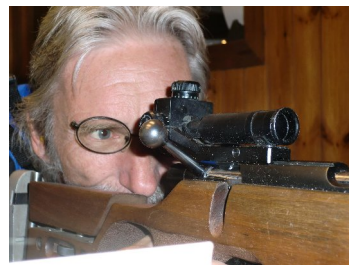
zorgt ervoor dat het richtende oog in de schiethouding door het midden van het glas kijkt.
