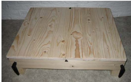
en de vloerplaat op het frame geplaatst
