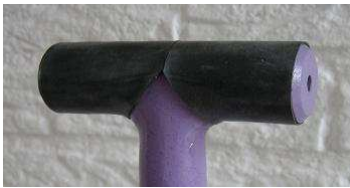
Een stuk binnenband om het oplegpunt geeft een stroef maar zacht oppervlak
