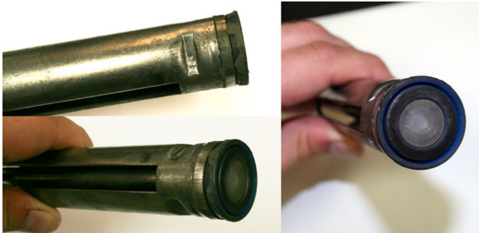
Een drijfveer met zware opbouw van koolstof en schade veroorzaakt door dieseling
