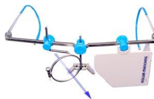
Bij een schietbril kan het optische middelpunt in de richtlijn, en het glas exact haaks op de richtlijn veresteld worden
