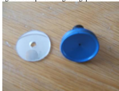
Spiegelend schijfje met irisopening (3mm), gezaagd uit een CD
