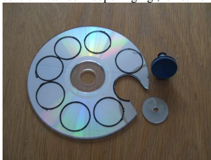
Spiegelend schijfje met irisopening (3mm), gezaagd uit een CD
